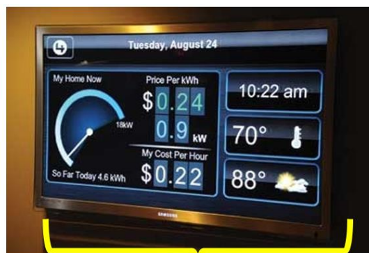
Smart meter (control4), ממוקם באזור מרכזי בבית, ממחיש באופן מיידי את השלכות השימוש בחשמל במדידת Kw וכן בעלות כספי בטווח מיידי.
